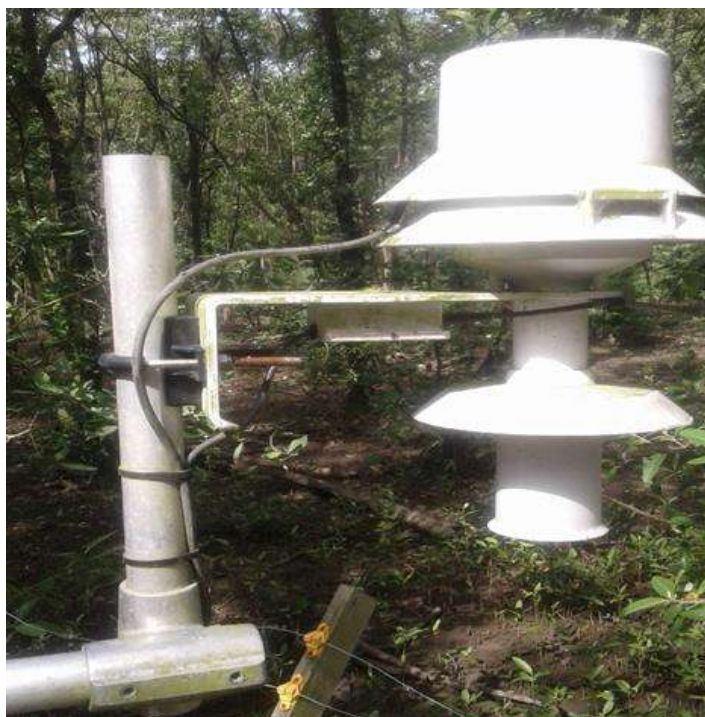
Figura 27. Sensor de temperatura y humedad relativa dentro de escudo contra radiación. Elaborada por: CIHH.
