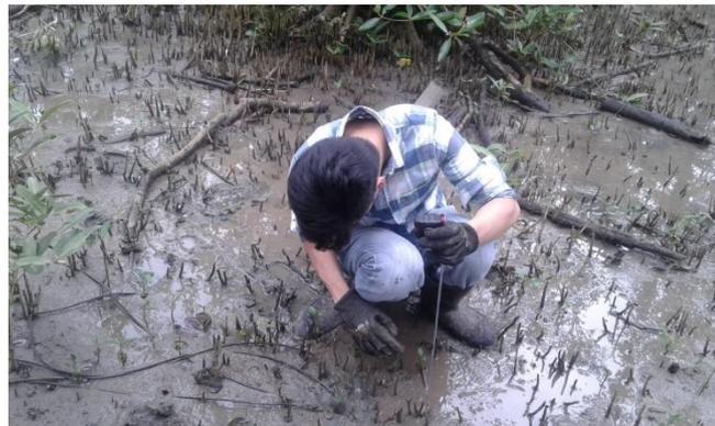
Figura 4 Medición de profundidad para instalación de sensores de temperatura de suelo en sitio B.
